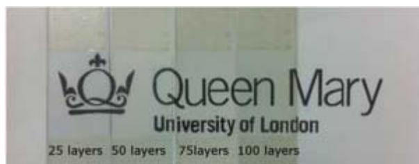
图8 喷涂方式分别制备的25、50、75、100双层沉积的PVA-GO复合薄膜光学照片<sup>[51]</sup>
