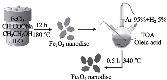
图 4 高温还原法制备磁性纳米片示意图 [38]
