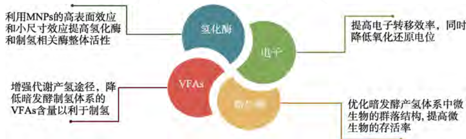
图 9 MNPs 在暗发酵过程中的作用机制
