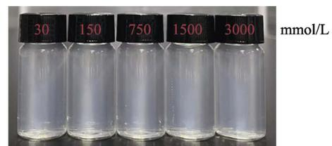
图 18 不同浓度 NaCl 溶液中 Q<sub>1</sub>-Z<sub>25</sub>-SC<sub>25</sub>-SC<sub>7.5</sub> 分散液的外观实物图
