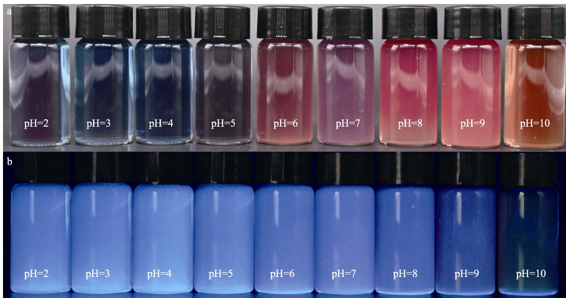
图 17 不同 pH 的 N-CDs 溶液在日光条件下 (a) 和紫外光激发下 (b) 的照片 Fig. 17 Photos of N-CDs solutions at different pH under daylight conditions (a) and upon ultraviolet light excitation (b)
