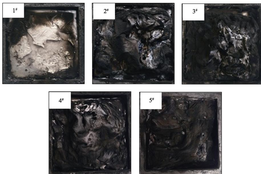
图 2 锥形量热测试后阻燃 PA66 复合材料残余炭层的照片
