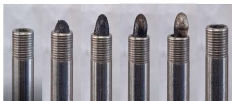
图 10 含油污泥凝胶体系注水突破过程
