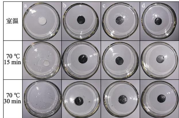
图 7 纯 PA (a)、PA/MXene-2% (b)、PA/MXene-11% (c) 和 PA/MXene-20% (d) 形貌稳定性照片
