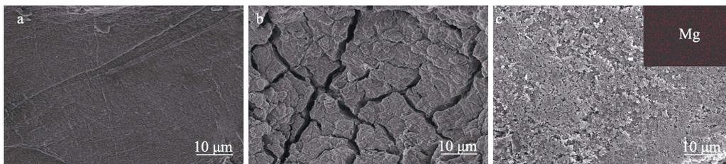
图 7 锂电电极循环前 (a)、在基础电解液 (b) 和含 0.3% MFS 电解液 (c) 循环 300 次后的 SEM 图 (插图为 EDS 分析)
