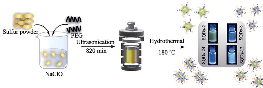
图 4 发射波长可控 SQDs 的合成示意图<sup>[41]</sup>
