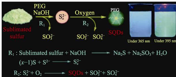
图 3 氧加速合成 SQDs 示意图<sup>[39]</sup>
