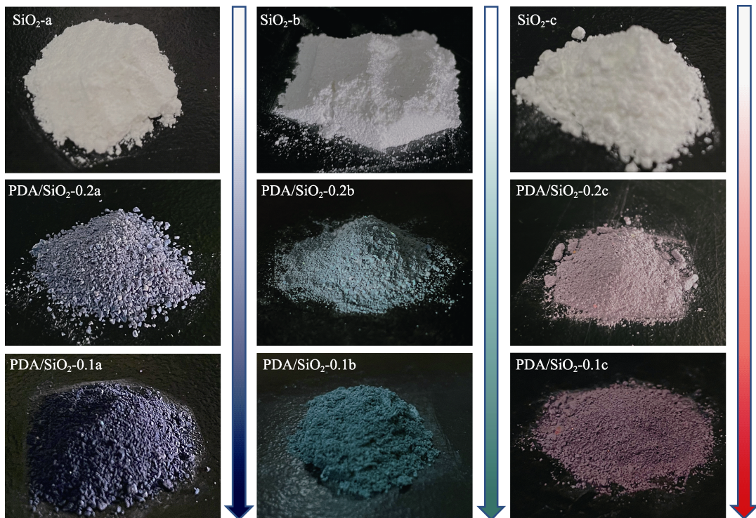
图 7 单分散 SiO 2 微球及非晶光子晶体 PDA/SiO 2 样品的光学数码照片
