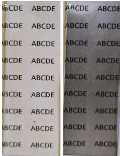
图 4 空白载玻片 (a) 和涂层载玻片 (b) 放在印有 ABCDE 白纸上的照片
