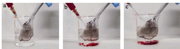
图 15 PDA 纳米片复合滤膜抗污染性能测试过程照片
