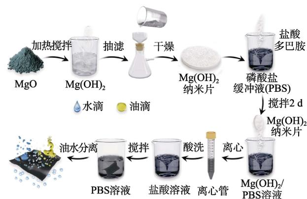
图 1 PDA 纳米片复合滤膜制备流程示意图
