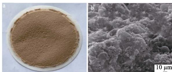
图 9 钻井液高温高压滤失实验滤饼照片(a)和 SEM 图(b)
