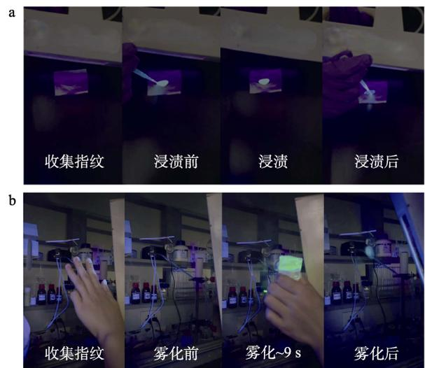
图 7 浸渍法使用 TTC-K ( $c=5 \times 10^{-5}$  mol/L) 在锡纸上 (a) 和雾化法使用 TTC-K ( $c=1 \times 10^{-4}$  mol/L) 在竖直玻璃 (b) 上的成像过程示意图
