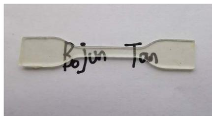
图 8 MAPTHF/N-100/TPO/BDO 体系固化弹性体实物图
