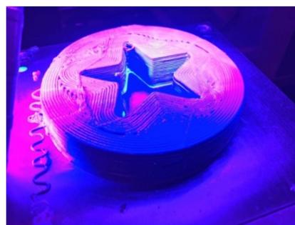
图 9 复合推进剂打印实验样件
